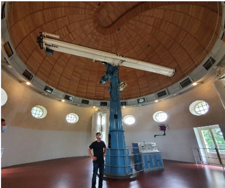
Abb. 8: Der Große Refraktor (B1) mit 60 cm Durchmesser und 9 m Brennweite (Länge) wurde 1911 von der Hamburger Firma A. Repsold & Söhne vollendet und mit zwei auswechselbaren Objektiven von C.A. Steinheil, München (für visuelle und fotografische Beobachtung), ausgestattet. Das Instrument wurde sowohl für Forschungen der klassischen Astronomie als auch zur Astrophysik verwendet. Foto: Uta Mense, 2021
