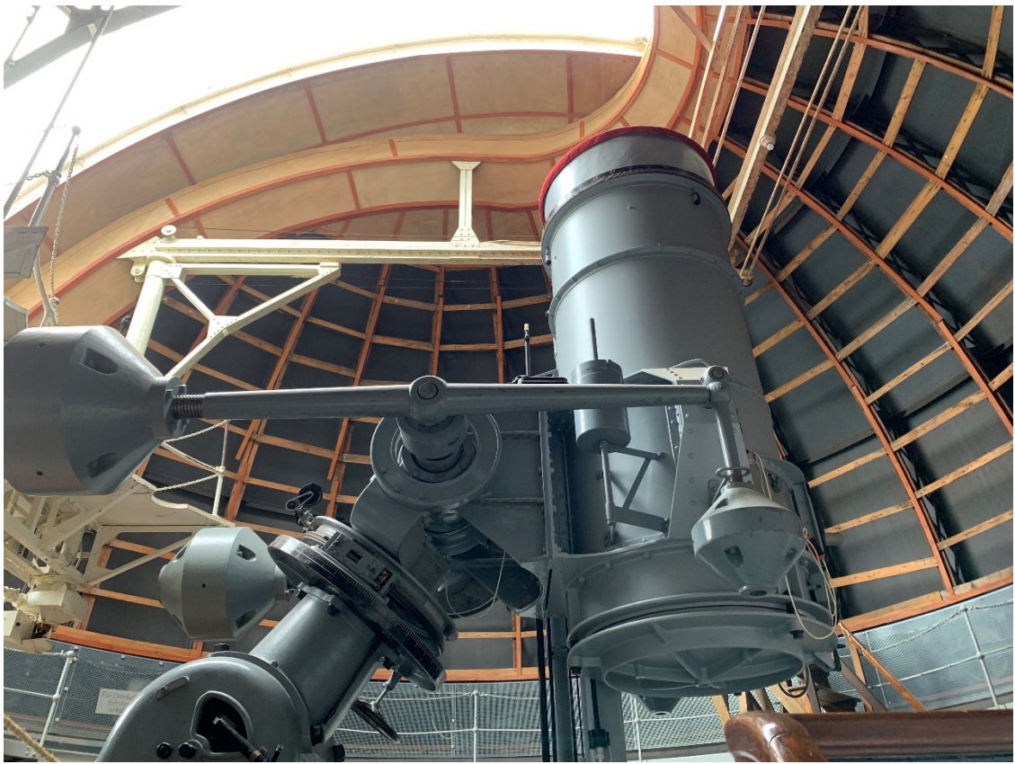
Abb. 15: Das 1-Meter-Spiegelteleskop (B4). Erstes großes Spiegelteleskop von Carl Zeiss Jena, fertiggestellt 1911. Es repräsentiert den astro-physikalischen Zweig der Forschung. Foto: Joel Rodriguez, Juli 2021
