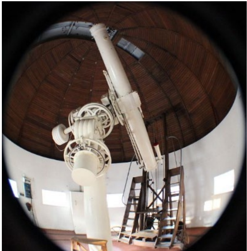
Abb. 12: Das Foto zeigt, wie der Beobachtungsstuhl von 1867 für das Äquatorial (B3), auf Schienen gelagert um 360° drehbar und in der Höhe beweglich, entwickelt und gebaut von Repsold, der das Teleskop alleine, also ohne Assistenz, bedienbar macht. Foto: Susanne M. Hoffmann, 2018
