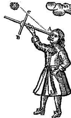
Abbildung 0.3: Jakobsstab, ein Winkelmeßinstrument für Astronomie und Navigation (John Seller (1603–1697): Practical Navigation (1672), Wikipedia)
